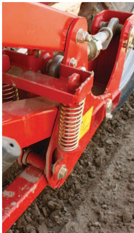
Radformingsplaten FLOW-BOARD med mekanisk settedybderegulering ved GB 215.
