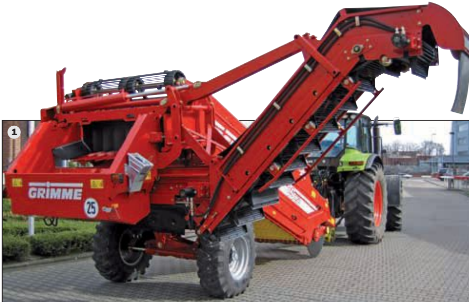
Lesse-elevator. Skulle det være ønskelig å fjerne steinen fra jorden kan det leveres elevator med 2 meters avlasterhøyde på høyre side (1).
