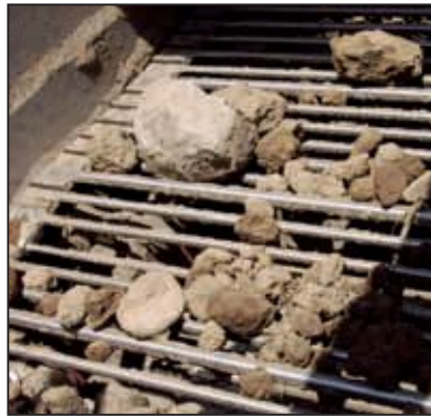
Hver sjette spile har en diameter på 16 mm. Det gir 3 viktige fordeler: Bedre transport av stein, bedre klumpknusing og større styrke på beltet, spesielt når det kommer inn stor stein.
