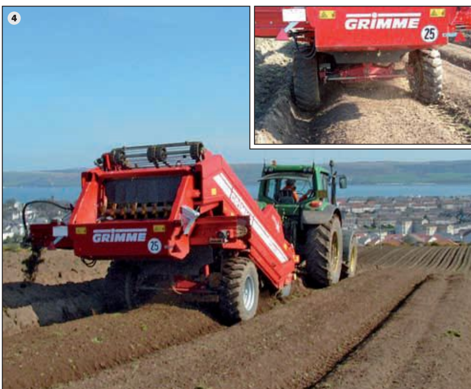
Avvatring. Den hydrauliske avvatringen (4) gjør det enkelt å holde maskinen horisontal i sidehellinger eller ved avvikende fårbredder. Et viktig bidrag til optimal separering og perfekte senger. Mer ekstrautstyr: automatisk avvatring.
