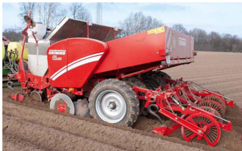
Opcionalmente la plantadora se puede equipar con un rodillo enrejillado o con conformador de caballones. Eso permite la adaptación óptima a las condiciones predominantes del suelo.
