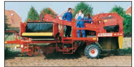
SE 75-20: til små eller mellemstore dyrkning-sarealer, særdeles kompakt (lav) konstruktion, Rullebundstank til 2.000 hhv. 2.300 kg
