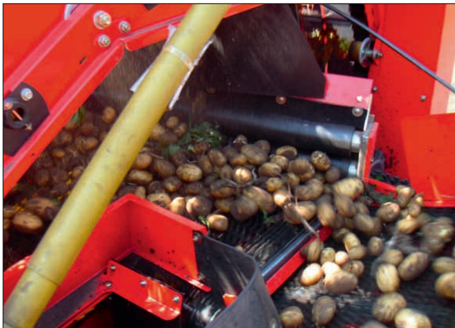
Manuel indstillelig: 6 Tilbageholdskamme på topkæden (hhv. 3 foroven og 3 forned).
