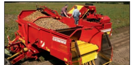
SE 75/85-55: 1-rækket, sideforskudt kartoffel-optager med 5.500 kg stor tank – nøjagtigt den rigtige til alle som søger efter optagningskapacitet mellem 1- og 2-rækkede maskiner
