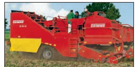
SE 150/170-60: 2-rækket, sideforskudt kartoffel-optager, yderst effektivt, robust og pålidelig, med stortank til 6.000, 7.000 hhv. 7.500 kg
