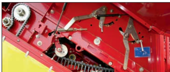
Manuel indstillelig: 6 Tilbageholdskamme på topkæden (hhv. 3 foroven og 3 forned).
