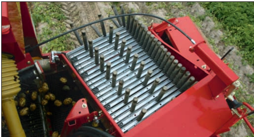
Fingerbåndets hastighed indstilles hydraulisk og trinløst.
