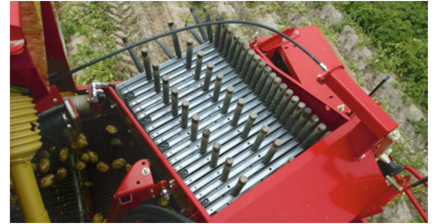
Sormisuistimen nopeutta säädetään portaattomasti hydraulilla.
