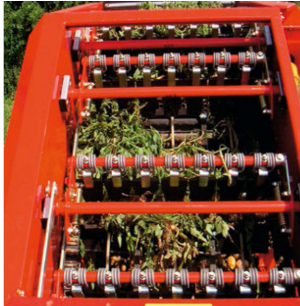
Perunoiden hellävaraista käsittelyä: varsimatto, jossa on pehmeät polyuretaanista valmistetut kolat (väli 210 mm tai 280 mm)
