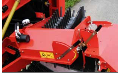
Sormimaton nopeuden voi säätää portaattomasti hydraulisesti.
