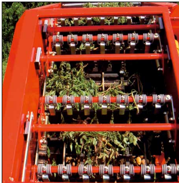
Perunaystävällistä käsittelyä: varsimatto, jossa on pehmeät polyuretaanista valmistetut kolat (jako 210 mm tai 280 mm)
