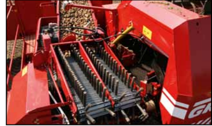
UB 900, kaksoissormimatto (lisävaruste): Parempia erotustuloksia kokkareisessa maassa
