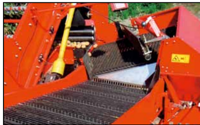
Tyyppi NB: Siilimaton ja suistitelan toiminta tapahtuu traktorin hydrauliiikan välityksellä.
