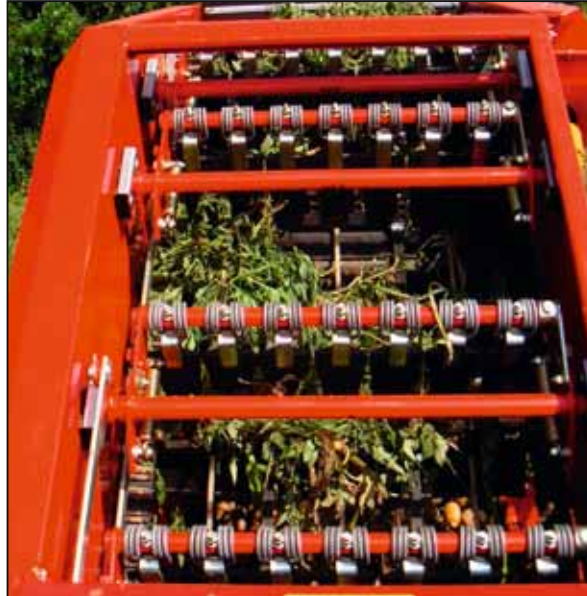
Optimal skonsam produkthantering: Grovblastmatta med mjuka PU-medbringare (avstånd mellan medbringarna 210 mm eller 280 mm)
