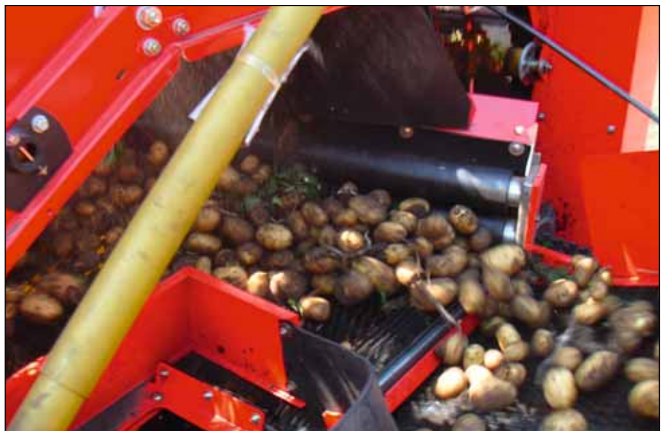
Steglös inställning möjligt som tillval: de sex återhållningskammarna (tre uppe och tre nere) på blastmattan.
