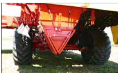
Frivillig uppsamlingsbehållare under försorteringsvalsarna
