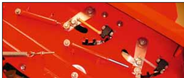
Steglös inställning möjligt som tillval: de sex återhållningskammarna (tre uppe och tre nere) på blastmattan.
