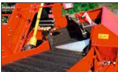
Typ NB: Gummipiggmatta och avstrykarvalsar drivs med traktorns hydraulik.
