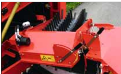
Fingermattans hastighet kan ställas in steglöst hydrauliskt.
