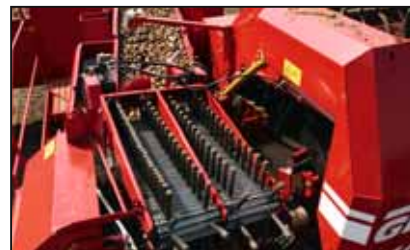
UB 900, dubbelfingermatta (tillval): Öka frånskiljningen på jordar med mycket jordkokor.
