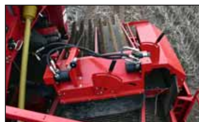
SB 900, dubbelborste (tillval): Ökade frånskiljningsresultat på stenrika jordar.
