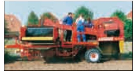
SE 75-20: для малых и средних площадей, особенно компактная (низкая) конструкция, бункер с донным транспортером на 2000 или 2300 кг
