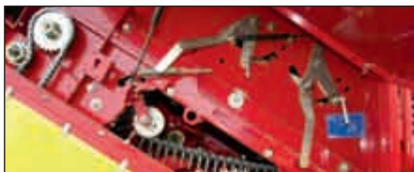
Ручная регулировка: 6 удерживающих гребёнок (3 сверху и 3 снизу) над ботвоудаляющим транспортером.
