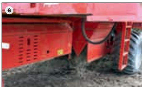
Приобретаемый в качестве опционального оборудования бункер для камней (6) ёмкостью около 500 кг. Загрузка осуществляется при помощи выгодно расположенных загрузочных шахт; опорожнение осуществляется механически посредством нажатия ножной педали на инспекционной площадке. Устройство гидравлического опорожнения с места водителя трактора приобретаемо в качестве опции.
