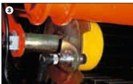
Быстрее реагировать: благодаря опционально устанавливаемому контрольному устройству пробуксовки привода 2-ого просеивающего транспортера (3) и 1-го сепарирующего устройства.
