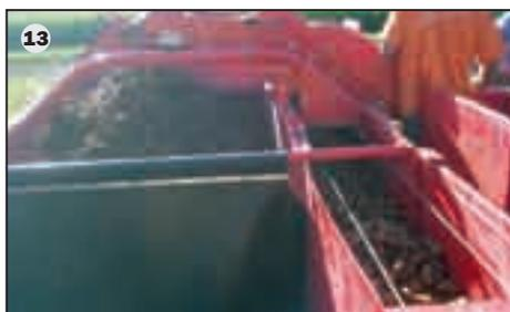
Использование четырёх сортировочных (опция) (12) позволяет отделять мелкие клубни, и в комбинации с разделенным бункером, независимо их перегружать.
