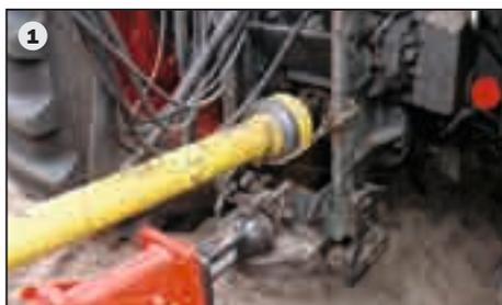
Альтернативно машина надёжно подсоединяется к трактору под валом отбора мощности. Для адаптации машины к различным типам тракторов, тяговая серьга регулируется по высоте (1).
