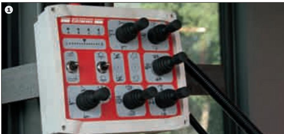
Из практики для практики: расположение подкапывающего устройства сбоку справа по ходу соответствует эргономике кабины водителя и обеспечивает простое управление машиной. Все основные функции машины, также как и опциональные: гидравлическая регулировка глубины подкола и функция разгрузки гребня, удобно управляются с места водителя (1).
