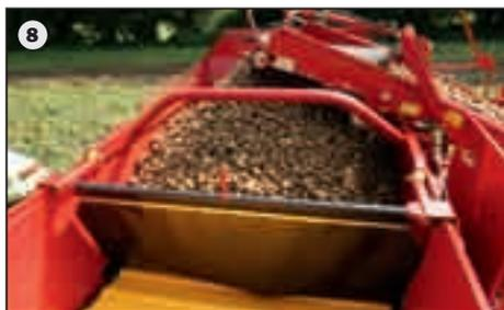
Минимальные ступени падения в процессе загрузки бункера с донным транспортером (7/8) благодаря гидравлическому поднятию и опусканию загрузочного транспортера. Воспользуйтесь преимуществами автотоники загрузочного транспортера (опция): при поднятии насыпного конуса в бункере загрузочный транспортер автоматически поднимается, обеспечивая неизменную ступень падения.
