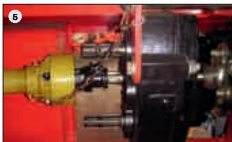
Не требующий техобслуживания привод 2-ого просеивающего транспортера и крупноячеистого транспортера для удаления ботвы (4) с карданным валом обеспечивает тихий ход машины.
