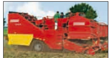
SE 150/170-60: 2-рядный, картофелеуборочный комбайн с боковым подкопом, чрезвычайно мощный, прочный и надежный, с большим бункером на 6000, 7000 или 7500 кг
