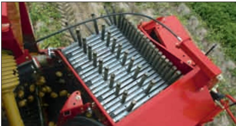
Скорость пальчикового транспортера регулируется бесступенчато.
