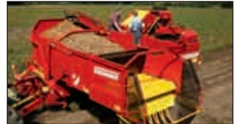
SE 75/85-55: 1-рядный, картофелеуборочный комбайн с боковым подкопом и большим бункером ёмкостью 5500 кг – то, что нужно для высокой производительности при использовании 1-о и 2-х рядных машин
