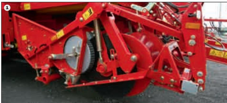
Хороший прием: установите угол подкапывающего лемеха для идеальной глубины подкола и используйте 2-х лопаточный лемех для тяжелых почв, и 3-х лопаточный лемех для средних и легких почв (2). Камнезащитные устройства (опция) обеспечивают дополнительную защиту лемеха от повреждения.
