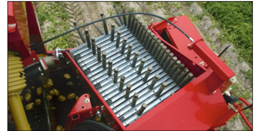
Fingermattans hastighet kan justeras steglöst hydrauliskt.
