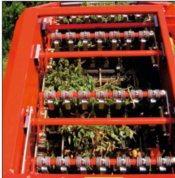
Optimalt skonsam produkthantering: Grovblastmatta med mjuka PU-medbringare (avstånd 210 m eller 280 mm)
