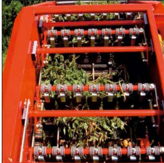
Un maximum de soin pour le produit : La chaîne effaneuse à grande maille est équipée avec des ameneurs caoutchoutés doux en PU (selon vos souhaits : pas de 210mm ou 280mm).
