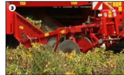
Une bonne prise : réglez l'inclinaison des socs pour un arrachage idéal en utilisant le soc à deux parties pour des sols lourds ou le soc à trois parties pour des sols légers à moyens (2). Pour une sécurité supplémentaire, profitez aussi de la protection « pierre » des socs d'arrachage en option.
