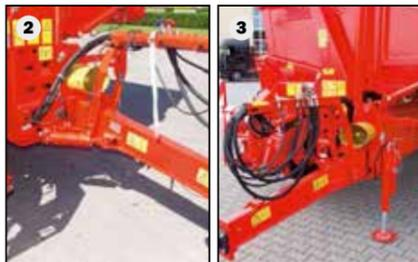
Mobile et fixe à la fois : Le cardan à angle large (option) et la béquille hydraulique (3).
