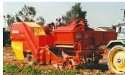
SE 75-20 : pour petites et moyennes surfaces, construction particulièrement compacte et basse, trémie à fond mouvant, capacité de 2000 / 2300 kg
