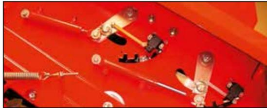
En option, les 6 peignes de retenues (3 en haut et 3 en bas) sur la chaîne effaneuse sont réglables sans à-coups hydrauliquement grâce à la technique digitale.
