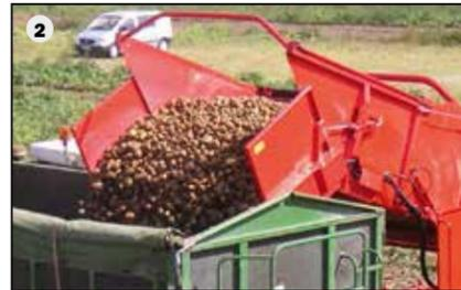
Vidange rapide et soignée: trémie aux grandes dimensions se lève aisément à une hauteur de déversement de 4,20 m grâce à un bouton. Le système de levage permet de conserver une position latérale de déversement quasi constante, quelque soit la hauteur de déchargement (1).
