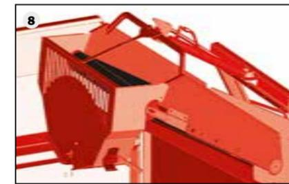
Ça fonctionne bien: Le système hydraulique pour rabattre l'amortisseur de chute permet d'écouler le flux de produit directement sans passer à travers la bêche palox. Cela vous assure également un chargement idéal même pour des remorques hautes (option) (7).
