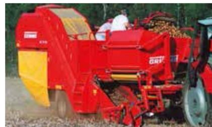
SE 75-30 : pour moyennes et grandes surfaces, construction compacte et rationnelle, trémie fond mouvant, capacité de 3000 / 3300 kg
