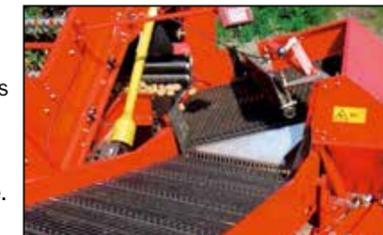
Type NB : Entraînement du tapis à tétines et du rouleau émotteur par hydraulique du tracteur
