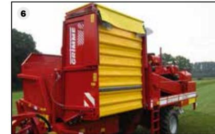
Les pommes de terre sont vidées tout en douceur grâce à la bêche pour déversement en palox (option) (5): pour un remplissage avec soin dans les véhicules de transport
