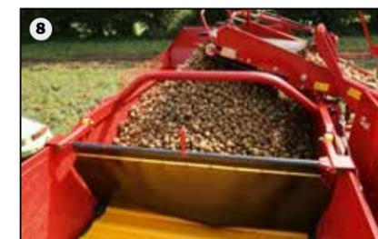
Des hauteurs de chutes minimales sont assurées au remplissage du fond mouvant (7/8) par l'action simple de lever ou de baisser le col de cygne. Profitez aussi de l'automatisme du col de cygne (option) : pour garder une hauteur de chute minimale et constante, votre col de cygne se relève peu à peu automatiquement en détectant le niveau de produit dans la trémie.
