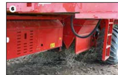
Bac à cailloux avec trappe de vidange (option) d'une capacité de 700 kg (6). Le remplissage s'effectue par des trappes montées pour un accès facile. La vidange s'effectue mécaniquement à l'aide d'un pédalier sous la bande de triage. Une vidange hydraulique à partir de la cabine ou de la bande de triage est disponible en option.
