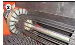
Grâce aux réductions de hauteurs de chute entre les différents tapis, le soin apporté à votre récolte est maximal (1). Le positionnement horizontal de la fin de 1<sup>ère</sup> chaîne adoucit la chute (2). L'encastrement du tapis à tétines entre les barreaux coudés de 2<sup>ème</sup> chaîne diminue la chute et permet le nettoyage des côtés du tapis.
