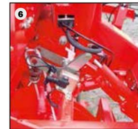
Un bon compromis : profitez du centrage sur buttes automatique en option (4). Grâce à deux capteurs montés sur le châssis du diabolo, le vérin de timon centre automatiquement le diablo sur la butte.
