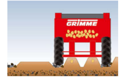
Phase 3: Kartoffeln legen im Beetlegeverfahren. Sofort nach dem Separieren werden die Saatkartoffeln im 1-, 2- oder 3-Beet-Verfahren gelegt.
