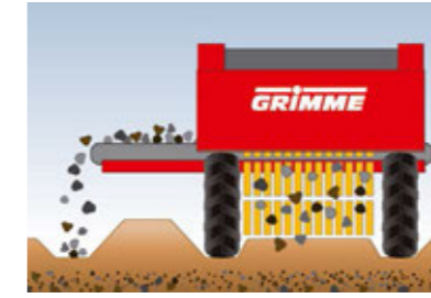
Phase 2: Beetseparierung mit dem Stein- und Klutenseparierer der CS-Serie. Der Separierer nimmt die ganze Beetbreite auf und sibt den Boden durch.
