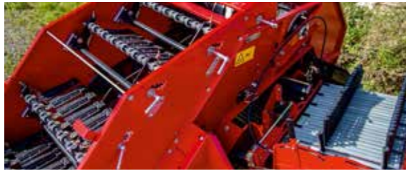
Ajuste manual: los 6 peines rastrilladores encima de la cinta de hojarasca gruesa
