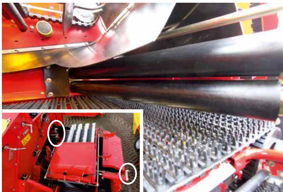
Efectiva separación de desperdicios y cuidadoso transporte del producto en uno
