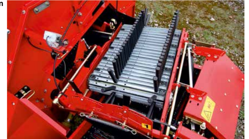
La velocidad de la cinta de dedos es ajustable hidráulicamente de forma continua.
