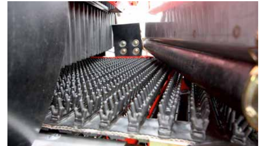
El rodillo deflector consigue una separación final de patatas y desperdicios sin pérdidas.
