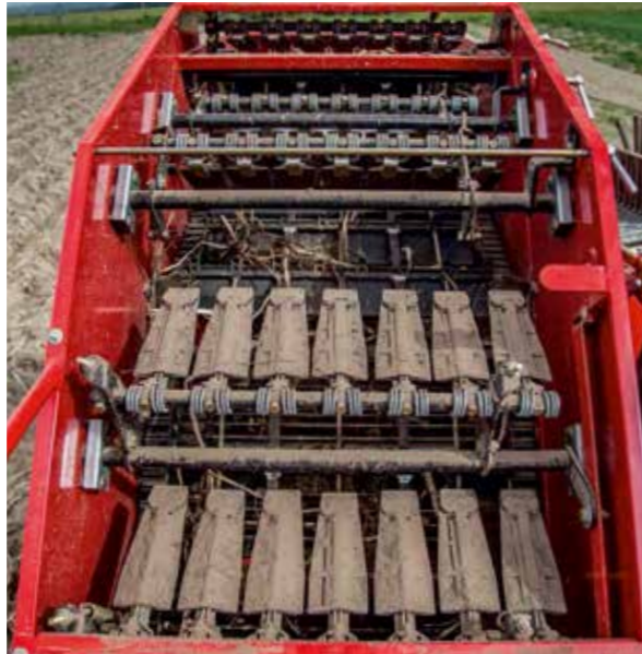
Óptimo cuidado del producto: cinta de hojarasca gruesa con arrastradores blandos de PU (distancia 210 mm)
