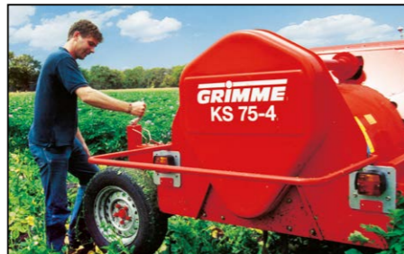
Pour une meilleure coupe : roues de jauges pour le réglage de la profondeur...
