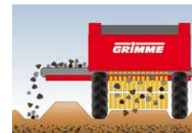
Fáze 2: separování záhonu se separátorem kamenů a hrud CS-série. Separátor nabírá celou šířku záhonu a prosévá zeminu.
