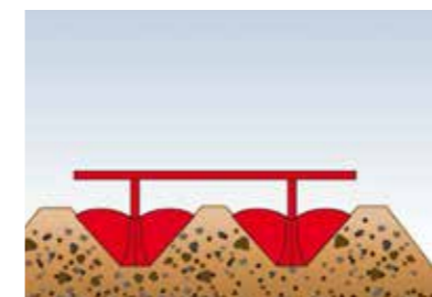
Fáze 1: tvarovače záhonu série BF/BFL tvarují záhon. Koleje a také šířka záhonu jsou v tomto kroku pevně zadány.
