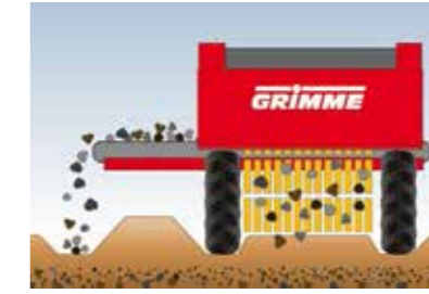
Fase 2: Separación del bancal con la separadora de piedras y terrones de la serie CS. La separadora introduce todo el ancho del bancal y criba la tierra.
