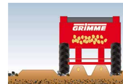
Фаза 3: Метод посадки картофеля в гряды. Сразу после сепарации картофель высаживается по 1-, 2- или 3-рядной технологии посадки в гряды.
