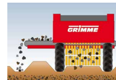
Фаза 2: Машины серии CS сепарируют камни и комки в гряде. Камнесепаратор охватывает гряду по всей ее ширине и просеивает почву полностью.
