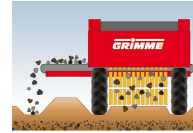
Phase 2 : Le tamisage du billon avec les séparateurs de mottes et de pierres de la série CS/ CW. Un tamisage sur toute la largeur du billon.
