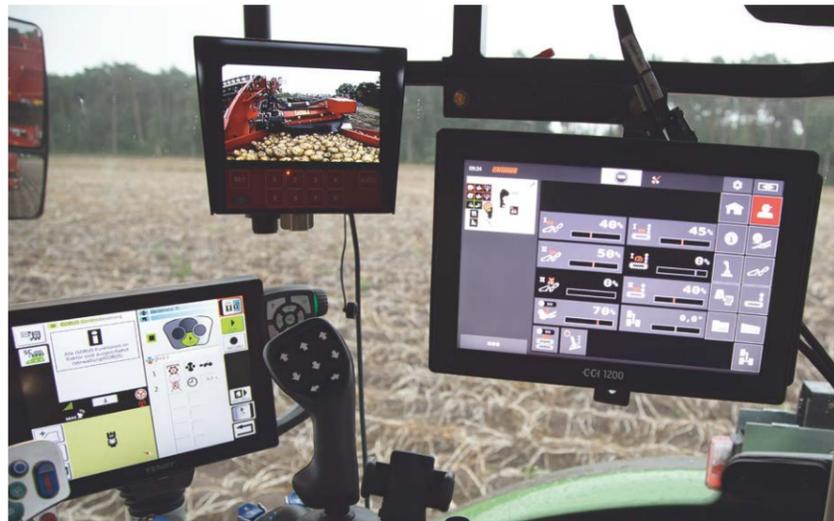
Durch die automatische Drehzahl-anpassung der Trenngeräte und des Verlesetisches an die Erntebedingungen schafft das optionale Speedtronic eine Erhöhung der Erntegutschonung bei gleichzeitiger Steigerung der Flächenleistung und eine umfangreiche Entlastung des Fahrers.
