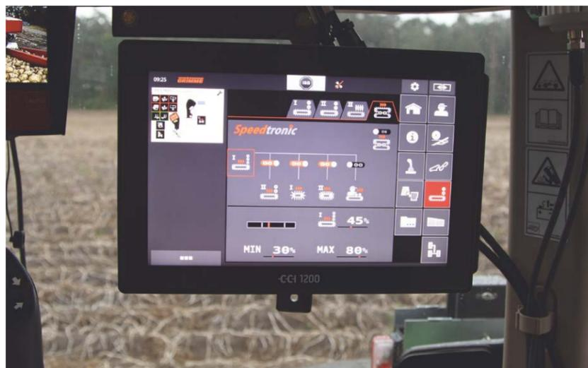
Com o MemoryControl, é possível o ajuste central dos acionamentos e dos aparelhos de separação. Os parâmetros de ajuste, como, p. ex., velocidades de rotação, ângulos de ajuste e valores limite podem ser guardados para diferentes condições de colheita e acedidos rapidamente premindo um botão, dependendo da situação. Até 8 programas podem ser armazenados desta forma, para poder efetuar colheitas de forma cuidadosa até orientada para o rendimento.
