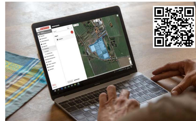
De série, todas as máquinas EVO 280 são equipadas com uma unidade de telemetria que transmite parâmetros de máquina e localização mediante pedido. O utilizador pode aceder e processar os dados na myGRIMME através do navegador.
