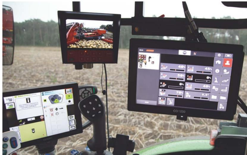
Através da adaptação da velocidade de rotação dos aparelhos de separação e da mesa de seleção nas condições de colheita, o Speedtronic opcional aumenta a proteção da colheita ao mesmo tempo que aumenta a quantidade de superfície tratada e alivia substancialmente o condutor.
