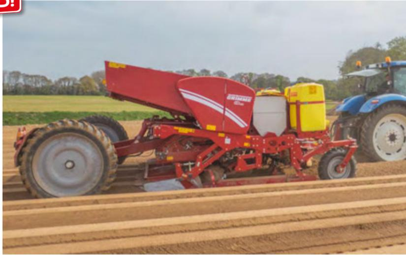
O acoplamento dos abridores de sulcos ao Flow-Board permite uma cobertura constante da semente, para uma brotação uniforme da cultura.
