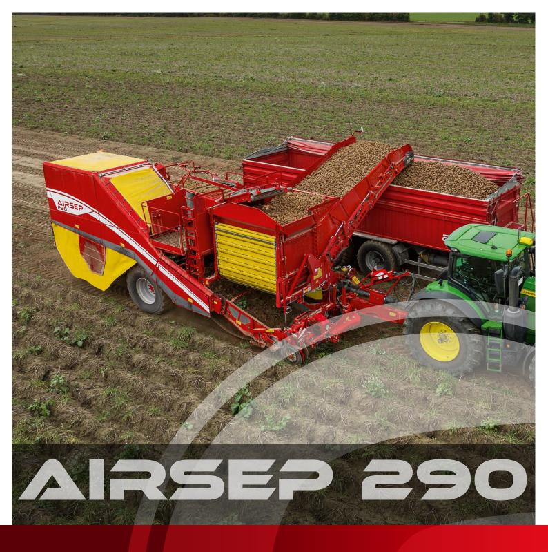
A AIRSEP 290 é uma colhedora de tremonha de duas fileiras com acionamento totalmente hidráulico, dispositivo de separação AirSep patenteado e uma capacidade da tremonha de série de 9 t.
